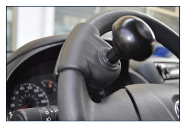
La boule au volant est utilisée lorsque le conducteur ne peut utiliser pleinement ses deux bras. Celle-ci peut être facilement retirée pour ainsi permettre la conduite confortable d'une personne valide.
