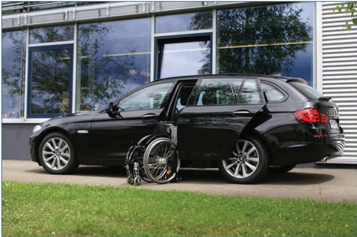
Le Robot chargeur est une solution de transfert de votre fauteuil roulant à l'arrière du véhicule. Installé à votre poste de conduite, vous pouvez gérer le rangement de votre fauteuil roulant en appuyant sur la télécommande fournie avec l'équipement. Le verrouillage du fauteuil roulant sur le bras s'effectue grâce à la télécommande. Cet aménagement permet la totalité de l'espace de rangement du coffre.
