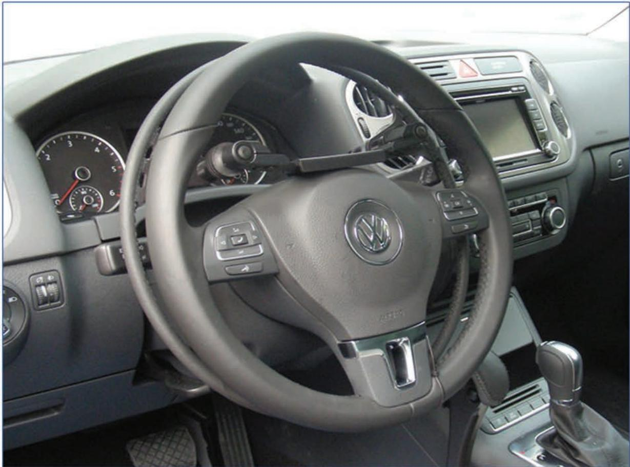
Le cercle sous le volant, doté d'un revêtement en cuir est capable d'accélérer en ramenant celui-ci vers le volant. La sécurité de l'utilisateur restant notre priorité, la fonction de l'airbag est maintenue et l'accélération est automatiquement interrompue en cas de freinage brusque. En respectant la position de conduite classique recommandée "10 heures 10", cela assure un meilleur contrôle du véhicule et augmente ainsi la sécurité avec une meilleure sensation de route.
