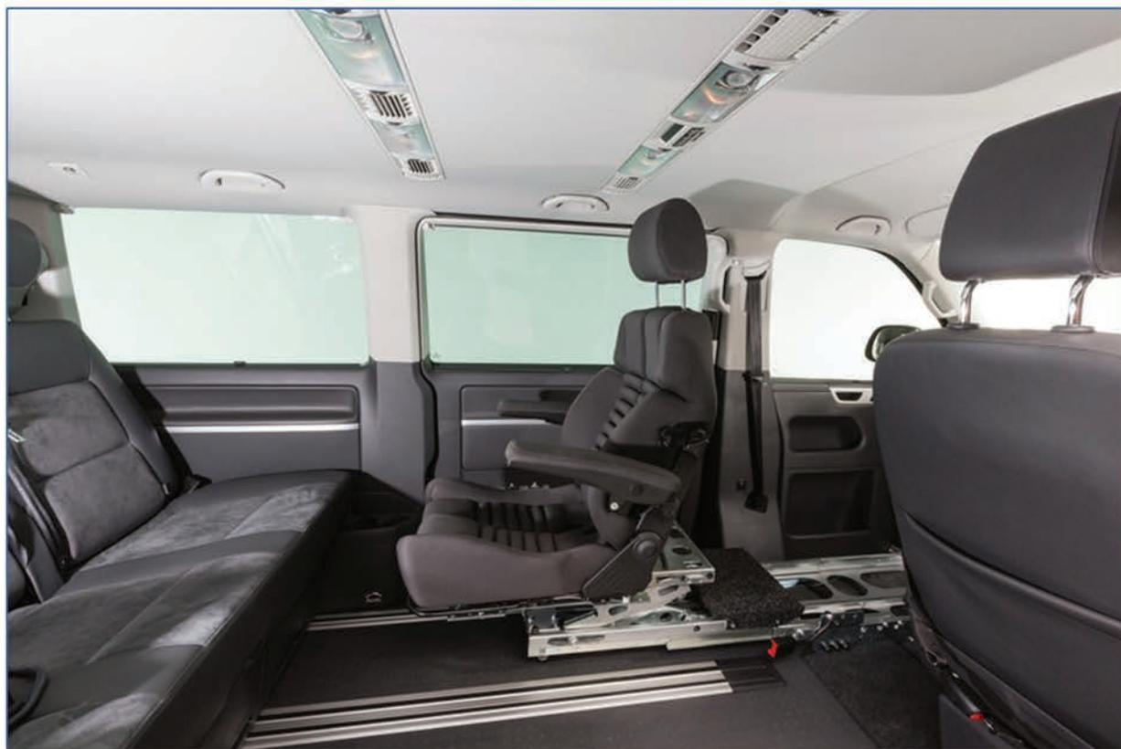
L'embase 6 positions PARAVAN entièrement électrique, placée sous le siège conducteur ou passager du véhicule, intègre 6 fonctions dédiées à faciliter les transferts.
