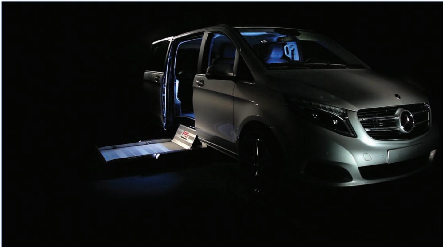
La hayon élévateur F6 est la solution afin de permettre à toute personne désirant se transférer dans son véhicule avec son fauteuil roulant par la porte latérale. L'une des particularité de ce hayon élévateur est qu'il se range sous le véhicule dans un caisson en acier inoxydable destiné à cet effet. Celui à l'avantage de ne pas encombrer l'habitacle. Une télécommande fournie avec la plate-forme permet de l'actionner simplement et sans aucun effort.
