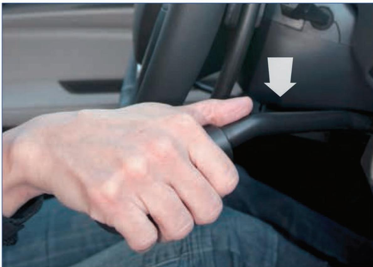
Ce levier de frein vertical, permet de freiner grâce à un court mouvement vers le bas. Etant en axe avec la pédale de frein, la force utilisée sur le levier y arrive multipliée.
