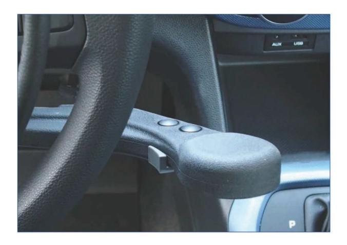
Ce levier de frein à long bras représente notre évolution la plus récente dans ce type d'équipement. Réalisé complètement en Aluminium et enrobé par une gomme rugueuse, il assure confort et durée.
