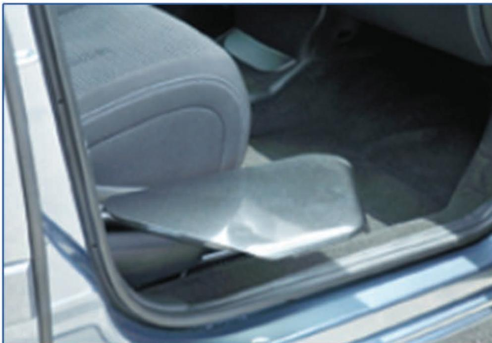
Le plateau de transfert à hauteur à hauteur fixe est un équipement mécanique qui permet de combler la largeur du bas de caisse afin de faciliter son transfert dans le véhicule depuis son fauteuil roulant. Placé grâce à une fixation type baïonnette, la tablette amovible à hauteur fixe bascule vers l'arrière du siège après avoir effectué son transfert pour ainsi ne pas gêner la conduite.
