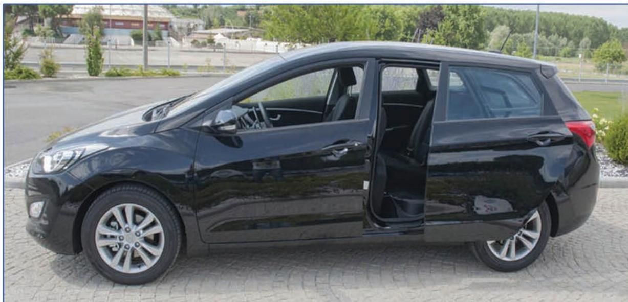
Celle-ci facilite le chargement du fauteuil roulant à l'arrière du véhicule. La porte escamotable peut être installée sur les véhicules 5 portes. Elle fonctionne à l'aide d'un moteur électrique relié à une télécommande ou un interrupteur. Activé, la portière recule et laisse un espace important afin de placer le fauteuil roulant dans le véhicule avec plus de simplicité. La porte ne fonctionne alors qu'électriquement.
