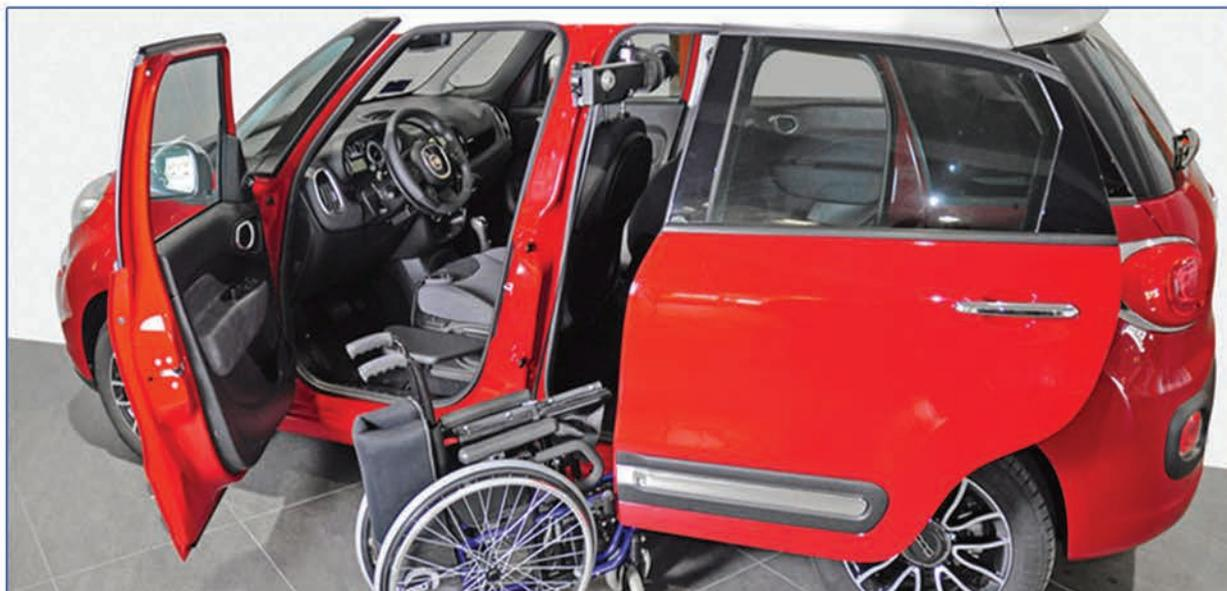
Le treuil est un bras articulé, installé sur le côté supérieur du montant. Celui-ci permet le chargement d'un fauteuil roulant manuel dans un véhicule à 3 ou 5 portes. La rotation du bras est manuelle tandis que la montée / descente du fauteuil roulant est électrique, piloté à l'aide d'une télécommande ou d'un interrupteur.
